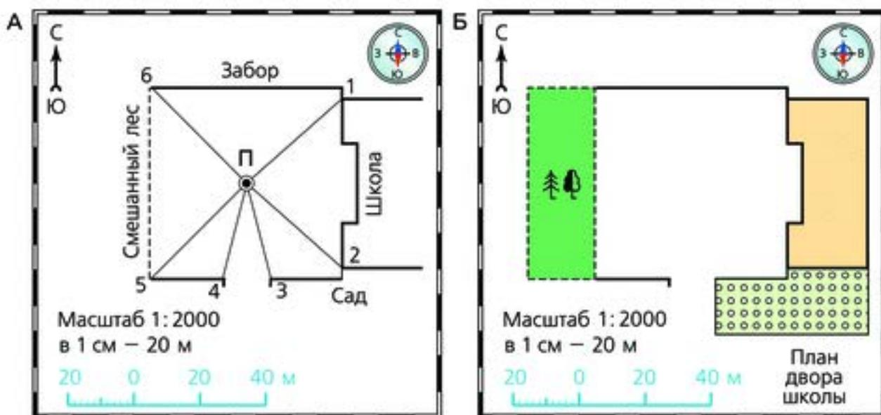
Рис. 16. Полярная съёмка:
