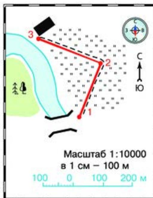
**Рис. 17.** Изображение на планшете после окончания маршрутной съёмки
