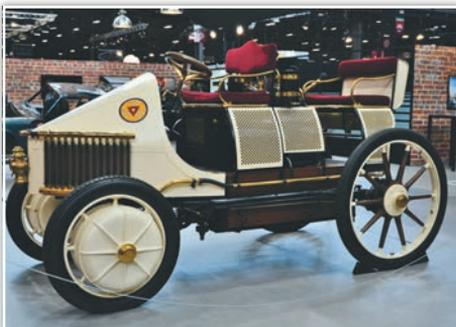
**Электрический автомобиль Ф. Порше с электродвигателями в каждом колесе, выпущенный в 1900 г.**
