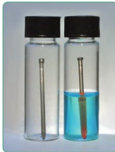
Рис. 67. Вытеснение меди железом из раствора сульфата меди(II)
