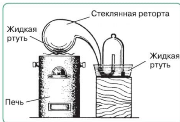
Рис. 40. Установка Лавуазье для изучения состава воздуха
