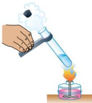
Рис. 47. Работа расширяющегося водяного пара вызывает движение пробки
