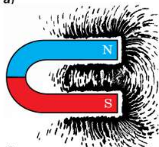
Рис. 127. Магнитные линии поля полосового и дугообразного магнитов
