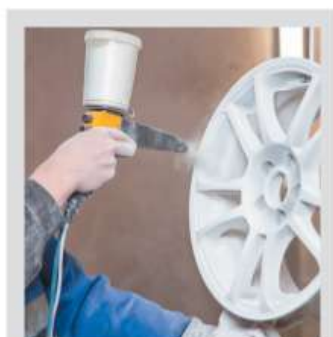
Равномерное окрашивание изделия наэлектризованной краской
