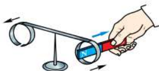
Рис. 171. При удалении магнита от сплошного кольца оно, притягиваясь, следует за магнитом
