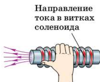
Рис. 133. Определение направления линий магнитного поля внутри соленоида
