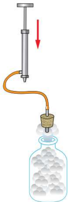
Рис. 12. Уменьшение внутренней энергии воздуха при совершении им работы
