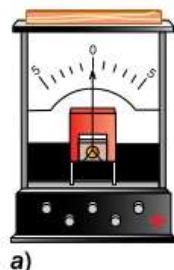
Рис. 87. Гальванометр: а — внешний вид; б — условное обозначение на схемах
