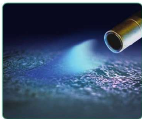
Рис. 17. Струя фтора, направленная на поверхность воды, вызывает появление голубого пламени
