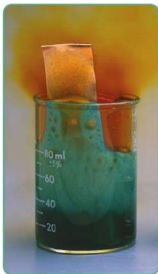
Рис. 39. При взаимодействии концентрированной азотной кислоты с медью один из продуктов реакции — бурый оксид азота(IV)
