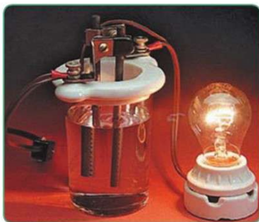
Рис. 7. Прибор для определения электропроводности растворов
