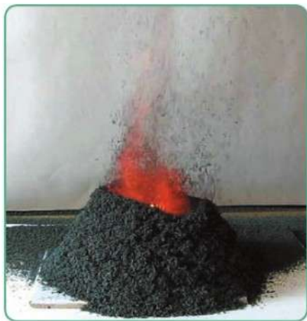
Рис. 37. Разложение дихромата аммония (химический вулкан)
