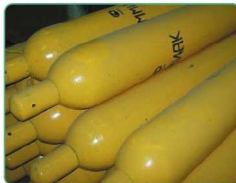
Рис. 36. Жидкий аммиак хранят и транспортируют в баллонах жёлтого цвета
